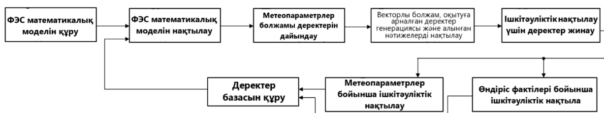
Сурет 3.7 – Теңгеруші топ құрамындағы ФЭС генерациясын болжау процесін автоматтандырудың құрылымдық сұлбасы
